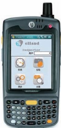
仪表读数工作。在移动设备上输入相应的仪表标签后，他就能直接在屏幕中输入读取的数值（总计用时不到30秒：共点击屏幕3次，使用手机数字键盘输入数字2次）。
